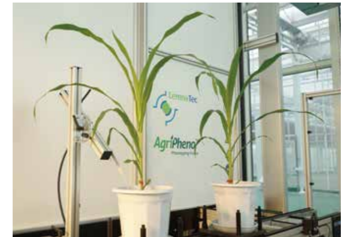
温室型高通量植物表型系统——Greenhouse Scanalyzer
