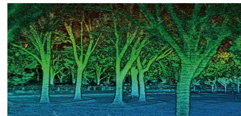
果树表型应用，可获知果树的冠幅、直径、高度、密度等信息
