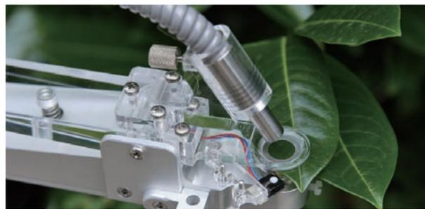
光适应叶夹，可测量温度、光强
