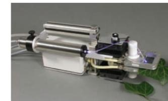
模式二(GFS-3000/F): GFS-3000 连接荧光附件 3050-F,在自然光下或人工光下同步测量气体交换与叶绿素荧光。
