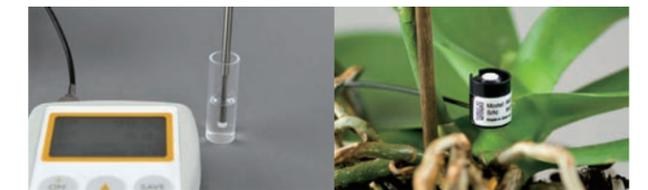
可以用来进行光强的简单测定，也可以作为连续测定的数据采集器。可以在单机模式下长时间（2个月或100天）连续记录环境PAR变化情况，并可显示数据变化图。如果通过USB与电脑连接后，则记录时间没有限制。
