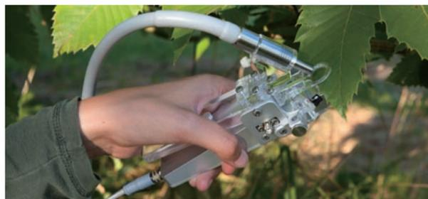
光适应叶夹，可测量温度、湿度、光强
